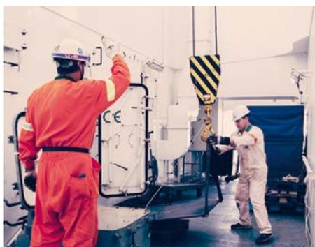
▲ Un code gestuel clair et connu de tous doit être utilisé pour les opérations de levage en sécurité.
