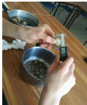
*Photo n°8 : mesure au pied à coulisse électronique*
